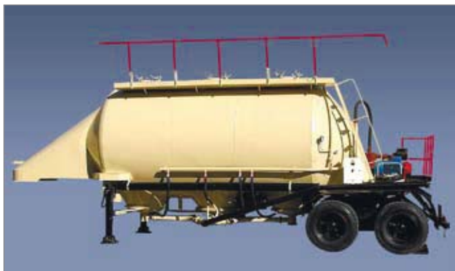
Напівпричіп АСП-25 забезпечує безтарне перевезення та пневматичне розвантаження матеріалів, що значно знижує трудомісткість цих робіт та економить пально-мастильні матеріали
